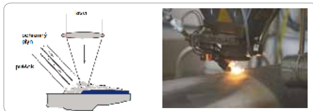
Obr. 3 Laserové naváranie s pretavením prášku [5]
